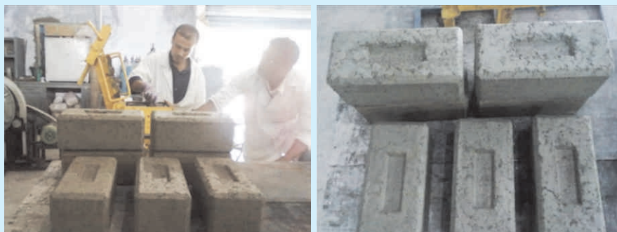
चित्र : टाइड लैंड के उपयोग से ब्रिक का निर्माण परिलक्षित।
